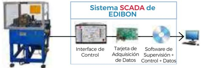
▶ **TBMC-CG.** Calorímetro de Gases de Escape, Controlado desde Computador (PC)
