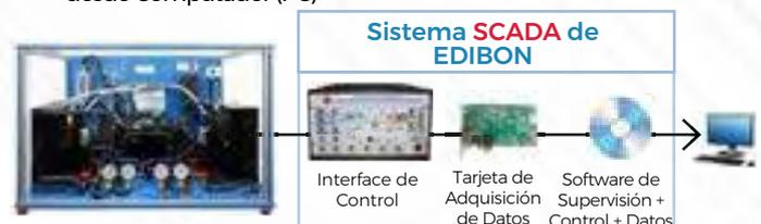
▶ **TRCAC.** Equipo de Circuito de Refrigeración con Carga Ajustable, Controlado desde Computador (PC)
