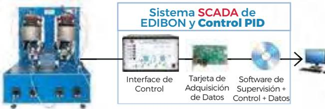
▶ **EBDC.** Equipo de Proceso de Biodiesel, Controlado desde Computador (PC)
