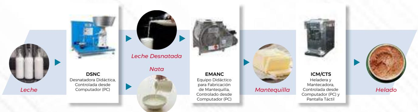
Con la Planta Piloto de **Producción de Nata, Mantequilla y Helado**, "LE00/CBI", diseñada por EDIBON, obtendremos leche desnatada, nata, mantequilla y helado.
