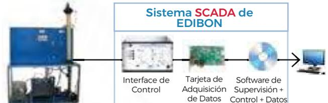
▶ **FPCC.** Equipo para el Estudio de Flujo en Columnas de Relleno, Controlado desde Computador (PC)
