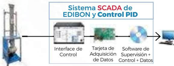
► **TIAAC.** Intercambiador de Calor Agua-Aire, Controlado desde Computador (PC)
