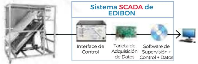
▶ **ECESC.** Colector de Energía Solar, Controlado desde Computador (PC)
