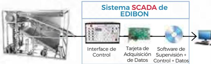
▶ **MINI-EESTC.** Equipo Básico de Energía Solar Térmica, Controlado desde Computador (PC)
