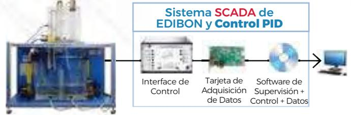
▶ **UCPCN.** Control de Procesos (Válvula Neumática), Controlado desde Computador (PC)
