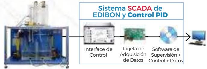
▶ **UCPCNCV.** Control de Procesos (Válvula Eléctrica + Neumática y Variador), Controlado desde Computador (PC)
