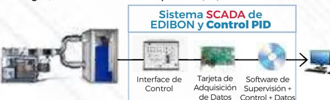
▶ **TSAC.** Equipo de Aire Acondicionado con Cámara Climática, Controlado desde Computador (PC)
