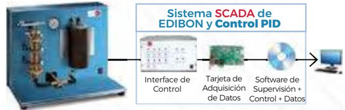
▶ **TSMEC.** Equipo de Motor de Vapor y Conversión de Energía Controlado desde Computador (PC)
