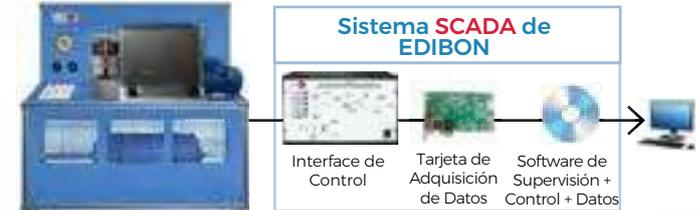
▶ **HCDEC.** Equipo de Ensayos de Compresor de Dos Etapas, Controlado desde Computador (PC)
