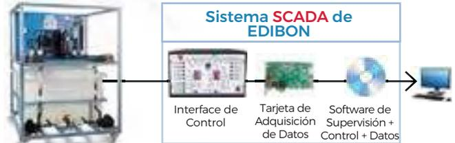
▶ **THALAC/I.** Equipo para el Control de Refrigeración con varios Compresores, Controlado desde Computador (PC)
