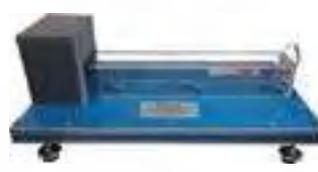
**RYC-TAR.** Módulo de Control de Temperatura de un Caudal de Aire
