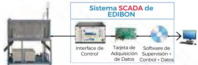
▶ **ROUC.** Equipo de Ósmosis Inversa/Ultrafiltración, Controlado desde Computador (PC)
