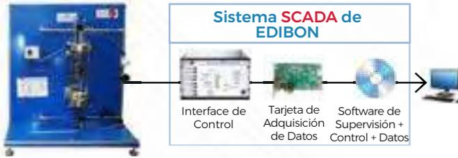
▶ **TFEC.** Equipo de Demostración de Flujo en Ebullición, Controlado desde Computador (PC)
