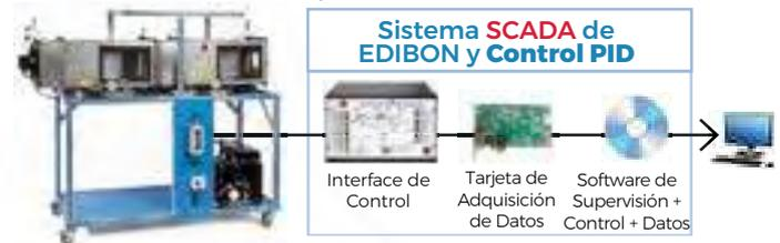
▶ **TARC.** Equipo de Aire Acondicionado (Recirculación), Controlado desde Computador (PC)
