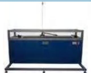
RYC-PI. Módulo de Control de Péndulo invertido
