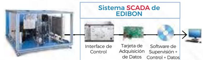
▶ **TACC.** Equipo de A/A con Cámara Climática y Enfriador de Agua, Controlado desde Computador (PC)
