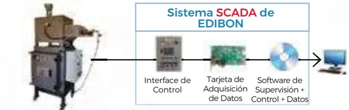
▶ **ROUC.** Equipo de Ósmosis Inversa/Ultrafiltración, Controlado desde Computador (PC)
