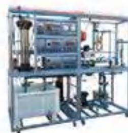
▶ **CTAC.** Sistema de Tanques Acoplados, Controlado desde Computador (PC)
