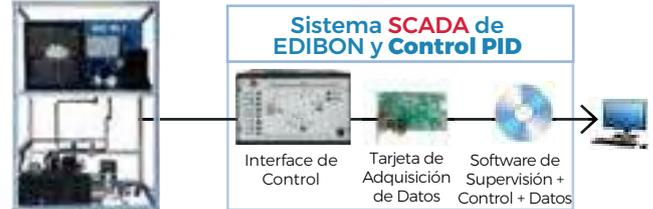
▶ **TRRC.** Equipo de Refrigeración con Cámara de Refrigeración y Congelación, Controlado desde Computador (PC)
