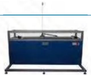
RYC-PI. Módulo de Control de Péndulo invertido
