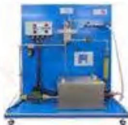
RYC-TAG. Módulo de Control de Temperatura de un Caudal de Agua
