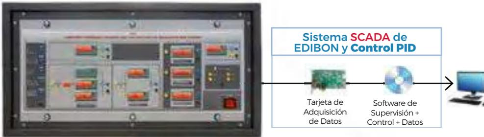
**RYC.** Equipo para el Estudio de Regulación y Control, Controlado desde Computador (PC)
