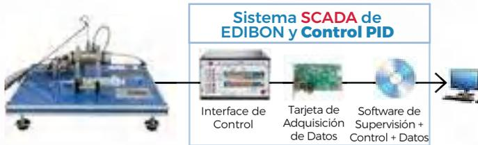
▶ **TCLFC.** Equipo de Transferencia de Calor por Convección Libre y Forzada, Controlado desde Computador (PC)
