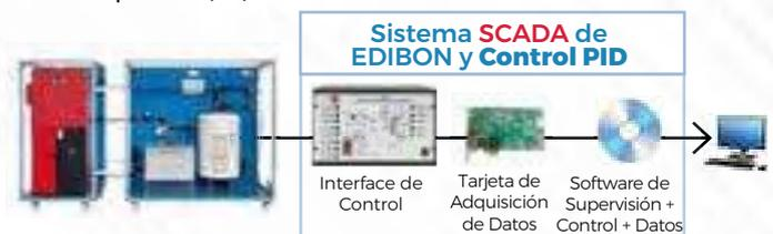
▶ **TEHSC.** Equipo de Estudio de la Eficiencia en un Sistema de Calefacción, Controlado desde Computador (PC)
