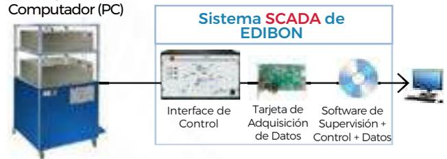
▶ **TSCAC.** Equipo de Sistemas de Conductos de Aire, Controlado desde Computador (PC)
