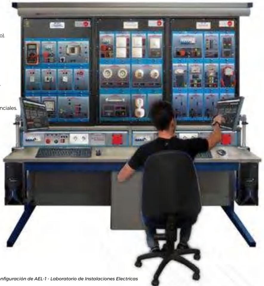
Ejemplo de configuración de AEL-1 - Laboratorio de Instalaciones Electricas
