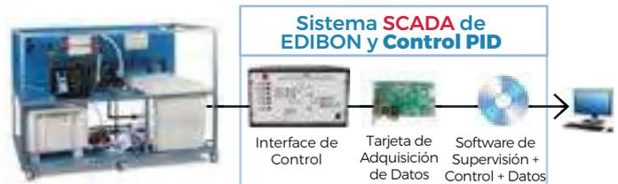
▶ **EFLPC.** Equipo de Filtración de Lecho Profundo, Controlado desde Computador (PC)
