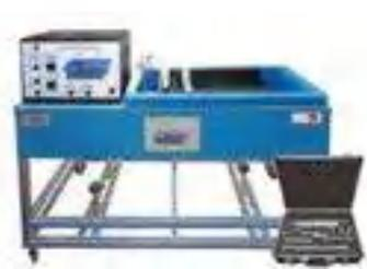
▶ **LFA.** Equipo de Visualización y Análisis de Flujo Laminar
