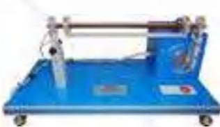
**RYC-BB.** Módulo de Barra y Bola
