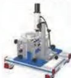
**MEMT-5.** Lubricación elastohidrodinámica
