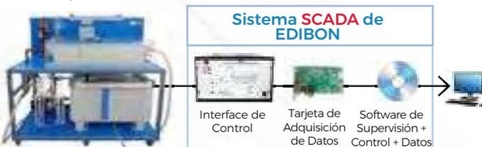
▶ **PDFDC.** Depósito de Filtración y Drenaje, Controlado desde Computador (PC)
