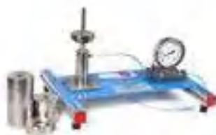
FME10. Calibrador de Manómetros
